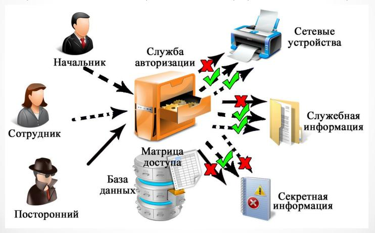
Полномочное (мандатное) управление доступом есть способ разового разрешения на допуск к защищаемому элементу данных. Заключается он в том, что каждому защищаемому элементу присваивается персональная уникальная метка, после чего доступ к этому элементу будет разрешен только тому пользователю, который в своем запросе предъявит метку элемента (мандат), которую ему может выдать администратор защиты или владелец элемента.
